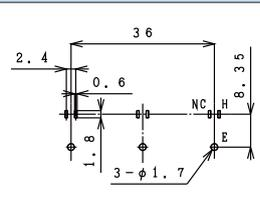
シールドプレート スイッチ付 / With Shield Plate & Switch
